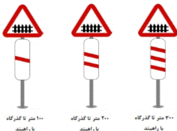
شکل ۲- تابلوی گذرگاه با راهبند برای راه جاده ای
