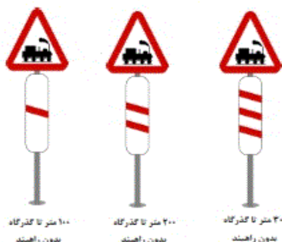
شکل ۱۳- تابلوی گذرگاه بدون راهبند برای راه جاده ای
